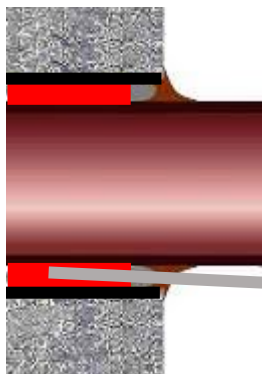
Rys. 4. Schemat uszczelnienia szczeliny pomiędzy rurami przy pomocy żywicy pęczniejącej.
